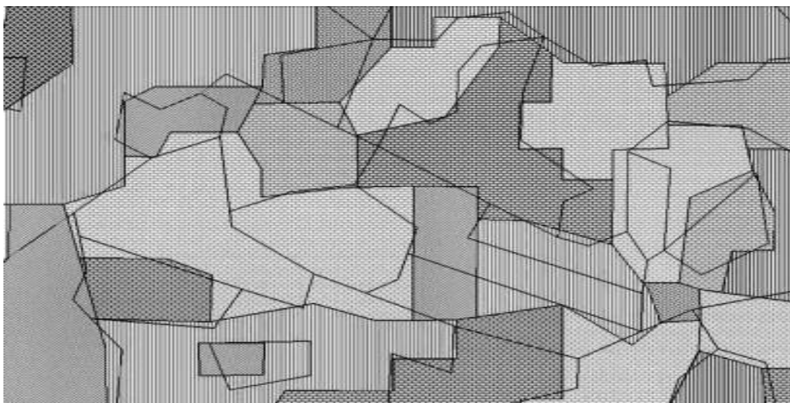
Figura 4: Comparación de paneles de control de ley utilizando ID3 (sombreados) y BEI (polígonos sin sombreado)
